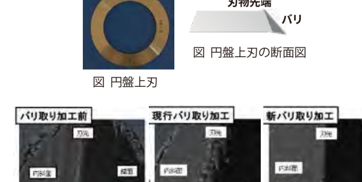
図 刃物製品のX線CT画像
